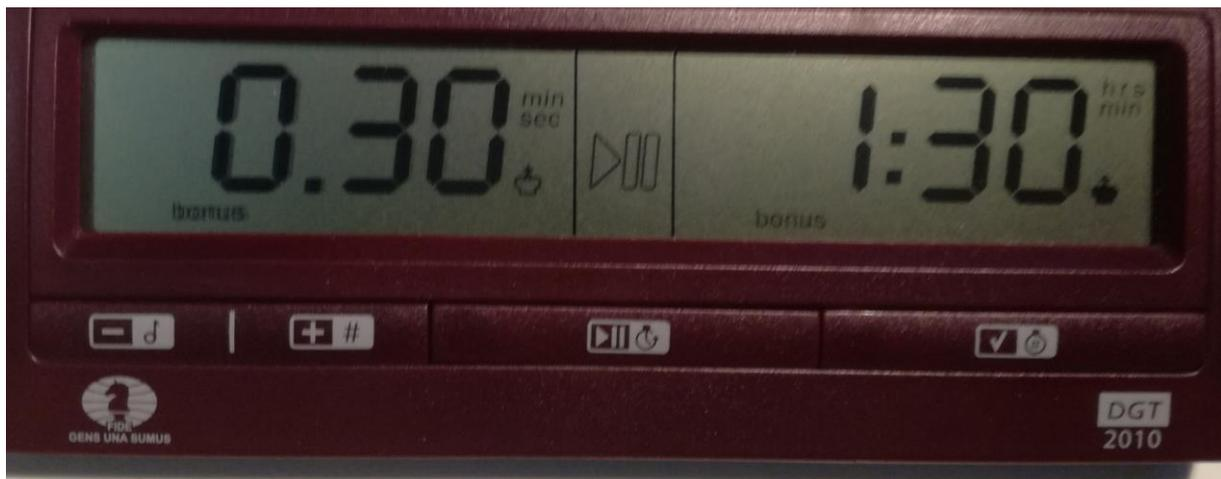
Dann Start drücken und die linke Uhr in Gang setzen ... nach 30 Sekunden sieht man ob die Uhr 15 oder 30 Minuten dazugibt.
